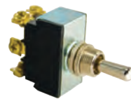
422667 ON/OFF/ON DPDT 6 SCREWS 10 AMPS/12 VOLT 15 AMPS/24 VOLT
