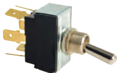
422668 ON/OFF/ON DPDTV 6 BLADES 10 AMPS/12 VOLT 15 AMPS/24 VOLT
